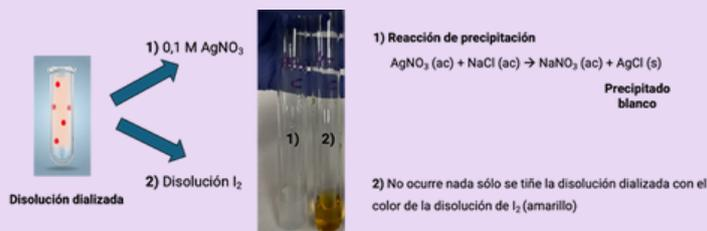
Figura 4. Comprobación del proceso de diálisis en la disolución dializada.
