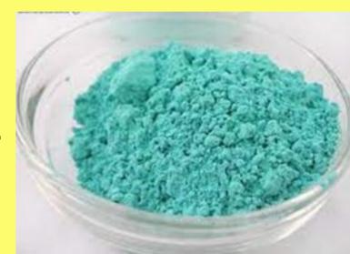
Imagen 4. Experimento didáctico en el laboratorio. Obtención a microescala de Carbonato de cobre a partir de una reacción entre sulfato de cobre y carbonato de calcio (reacción de precipitación)
