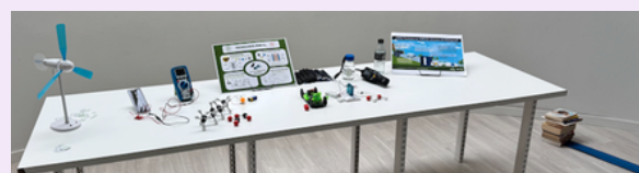
Figura 1. Descripción general del montaje experimental utilizado en el taller de hidrógeno, que incluye fuentes de energía renovables (panel solar, turbina eólica), un electrolizador PEM, una pila de combustible de hidrógeno y modelos moleculares para la visualización conceptual.
