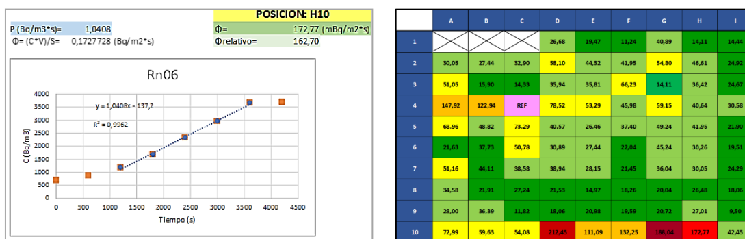
Fig.2. Determinación de la cinética de inmisión superficial (mBq/m²·s) en un punto (izquierda) y resultados obtenidos en toda la superficie monitoreada (derecha).
