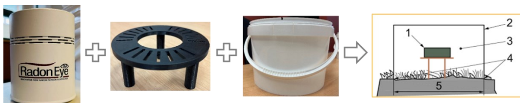
Fig.1. Montaje experimental para determinar la cinética de inmisión de radón (UNE-EN ISO 11665-7).
